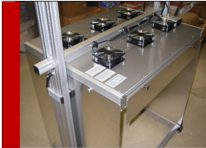
Abb. 5 STIR ® -Modul zum Gelieren von Plastisol (Draufsicht)
